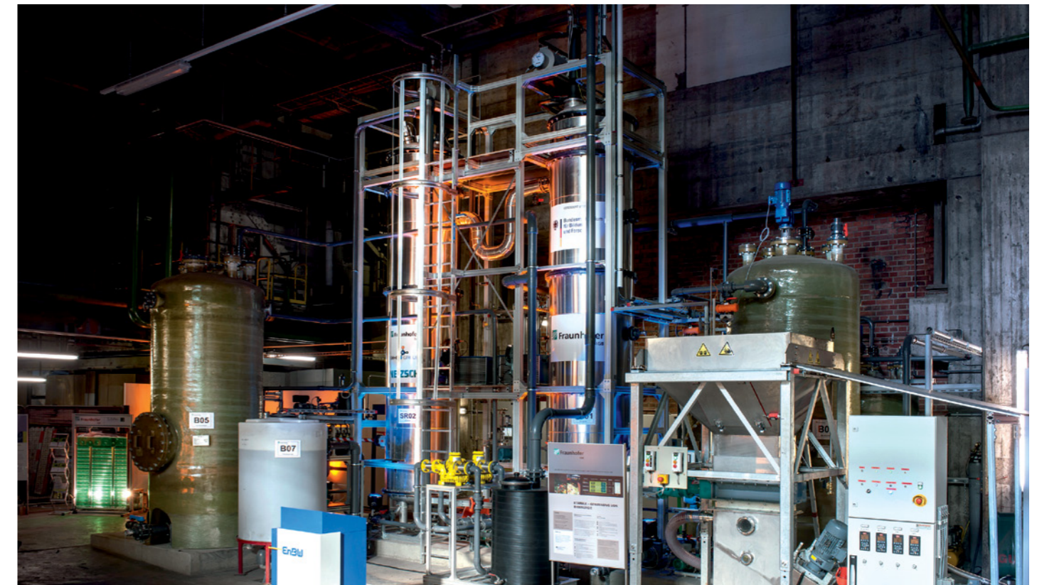
In der EtaMax-Pilotanlage in Stuttgart werden Abfälle vom Großmarkt zu Biogas und Wertstoffen verarbeitet. / The EtaMax pilot plant in Stuttgart converts biological waste accruing in Stuttgart Central Market into biogas and reusable materials.
