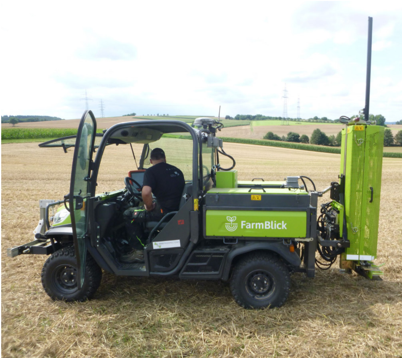
Der KUBOTA RTV-X900, der von FarmBlick für die georeferenzierte Bodenbeprobung umgebaut wurde (Bohrer im Heck). Durch die exakte Dokumentation des Entnahmepunktes kann die gleiche Stelle wieder gefunden und wiederholt beprobt werden. Foto: Oliver Martin, Farmblick, Kraichtal
