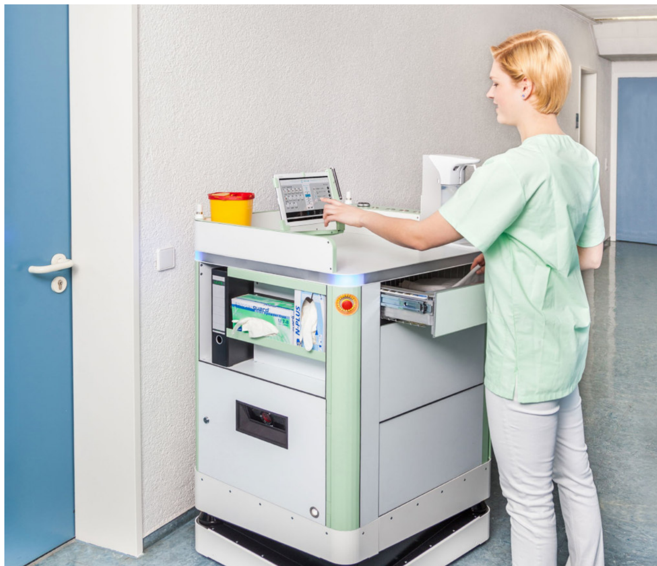
Der intelligente Pflegewagen navigiert autonom und erspart den Pflegekräften weite und zeitaufwendige Laufwege. Foto: Fraunhofer IPA / Heike Quosdorf
